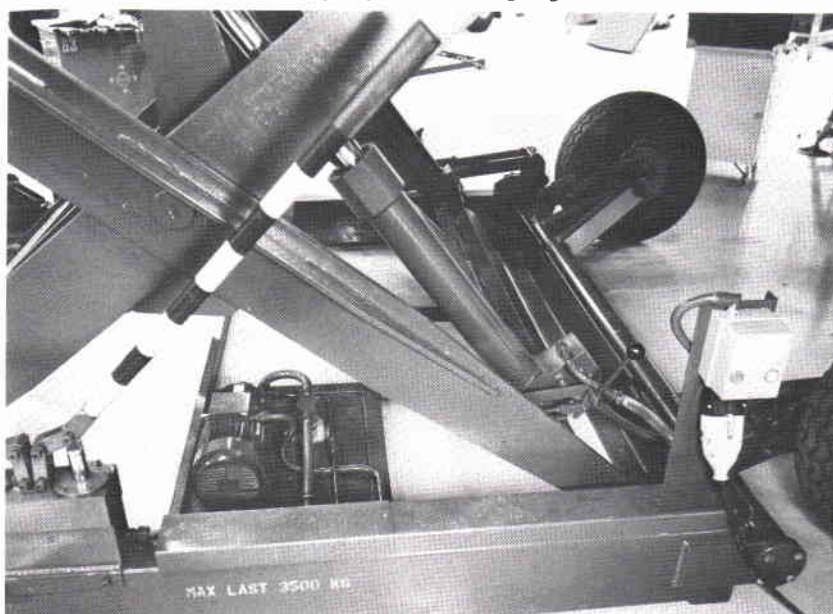
Den lilla elmotordrivna hydraulpumpen i hanteringsvagnen
